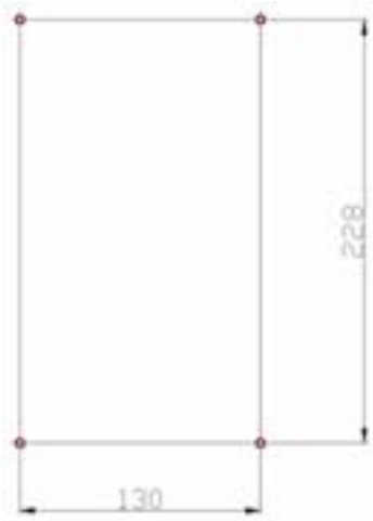
Рисунок 2.1. Разметка отверстий для крепления источника на плоской поверхности
